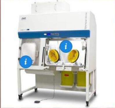
Ce sont des **enceintes ventilées** assurant une protection du manipulateur et de l'environnement vis-à-vis de substances dangereuses et du produit manipulé vis à vis des contaminations microbiologiques.
