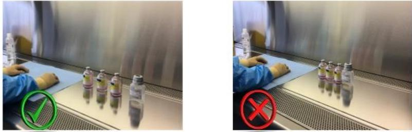
Il y a un risque important de perturbation du flux laminaire si les objets sont trop proches les uns des autres.
