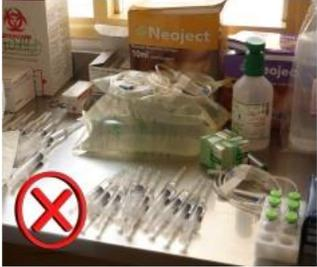
Un objet perturbe le flux d'air sur une distance équivalente à 3 fois son diamètre.
